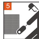
**涂刷施工:** 用毛刷在灶台上涂刷作业, 采用十字交叉方式进行, 以防止漏刷, 参考
