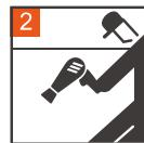
**干燥处理:** 将清洗干净后的灶台基面用吹风筒等进行烘吹干,
