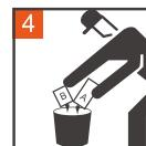
**精准配料:** 将房小宝金钢膜的A组份、B组份按1:0.6的重量配比混合均匀;
