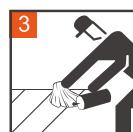
**擦界面剂:** 用抹布蘸取少量砖面处理剂, 在灶台表面反复擦拭
