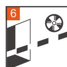
**现场保护:** 施工完毕后, 保护现场, 保持室内通风, 6-8小时即干燥。
