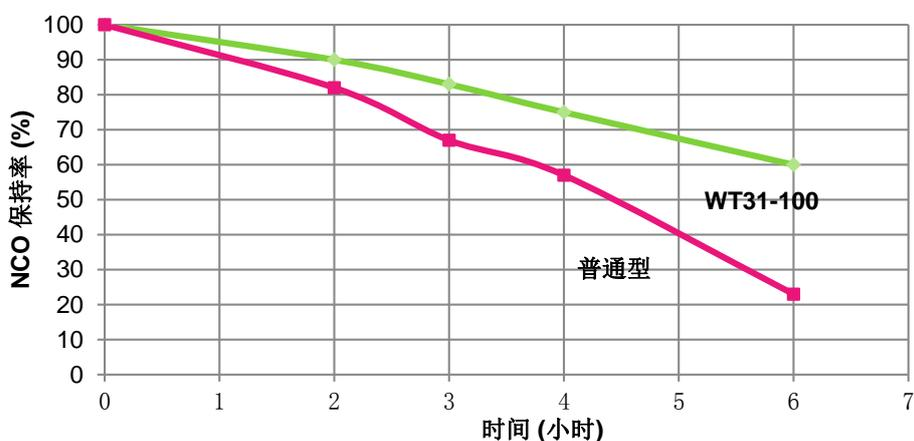
NCO保持率：测定40%水分散液状态下的NCO的含量。样品放置于25℃，65%湿度环境下，每隔一小时测定一次数据。
